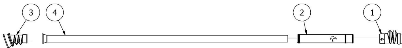
Rysunek 19 SI01715-07 Kompletna rura teleskopowa do rednicy stopkowej długiej
