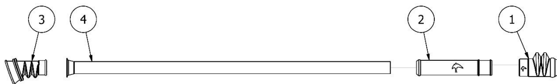
Rysunek 15 SI01715-06 Kompletna rura teleskopowa do redlicy krótkiej z telerem czyszczącym
