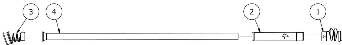
Rysunek 16 SI01715-09 Kompletna rura teleskopowa do redlicy długiej z lemieszem czyszczącym i talerzem czyszczącym
