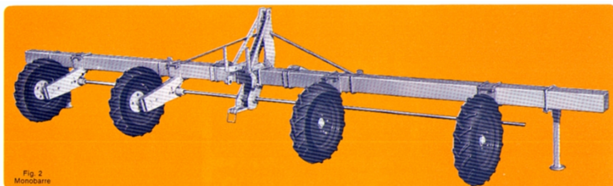
Fig. 1. Rama siewnika 4-rzędowego do kukurydzy / 6-rzędowego do buraka.
