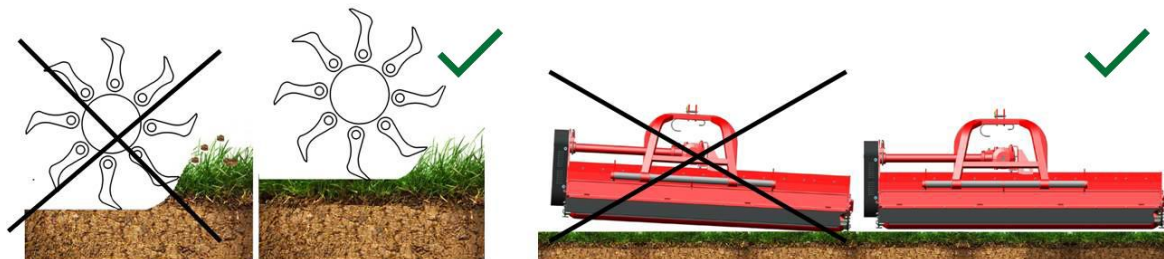
Ilustracija 15: Regulacija maszyny podczas pracy
