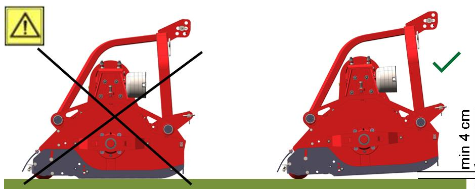
Ilustracja 14: Ustawienie wysokości roboczej
