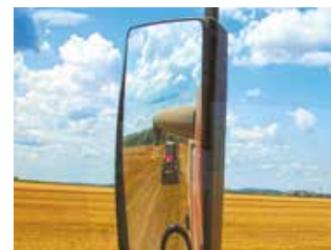
Większa widoczność dzięki lusterkom skierowanym na tylne koło.
