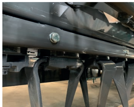
Listwa zabezpieczająca przed kamieniami
