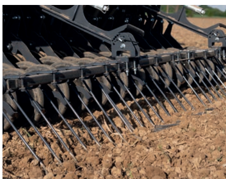
Tyłny zagarniacz z palcami niwelującymi, z regulacją kąta pracy i docisku
