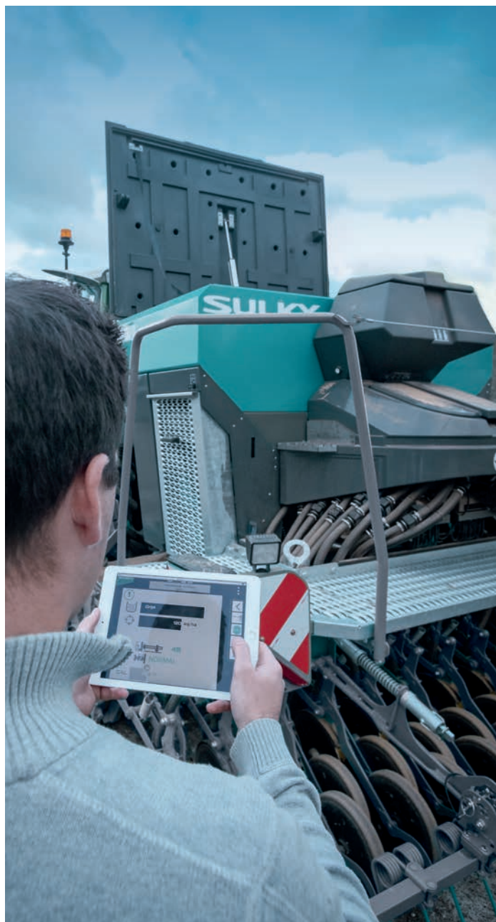
Zdalne otwieranie pokrywy zbiornika
