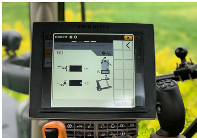
Elektryczna regulacja głębokości wysiewu (dla wersji Twindisc) - 12-2020
