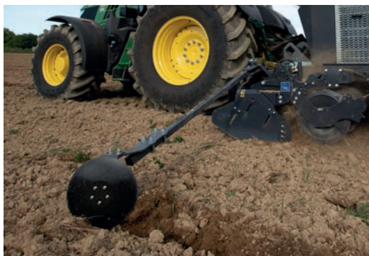
Znaczniki przejazdów montowane na bronie wirnikowej
