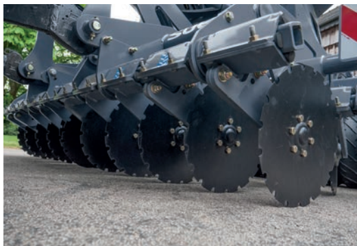
Talerze spulchniające ślady na agregacie talerzowym XR
