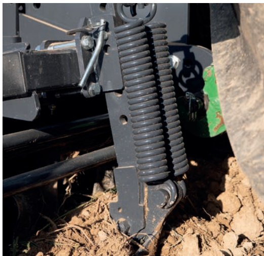
Spulchniacze śladów z zabezpieczeniem Non-Stop
