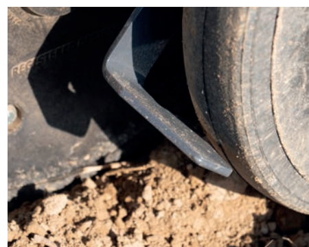
Skrobak koła dociskowego (dla wersji talerzowych Cultidisc i Twindisc)
