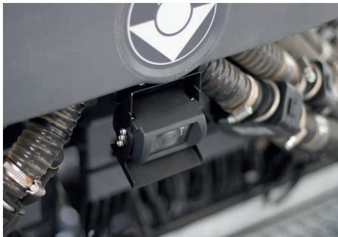
Kamera HD (możliwa w wyposażeniu z zestawem sterującym QUARTZ 800)
