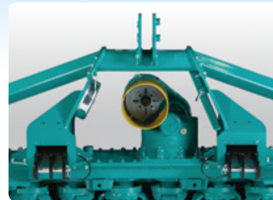
3-Monoblokowy układ zaczepienia umożliwia współpracę z siewnikami o dużej pojemności zbiornika na ziarno.
