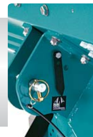
Strzałka ustawienia w poziomie i pod kątem dla rozsiewu późnego
