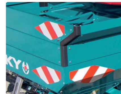
Szeroka nadstawka zbiornika dla uzyskania szerokości załadunkowej 2,80 m (opcja)
