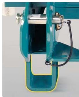
Stopy podporowe dla ułatwienia przyłączenia / odłączenia rozsiewacza (opcja)
