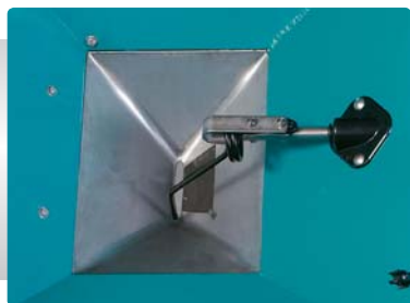
Strzałka ustawienia w poziomie i pod kątem dla rozsiewu późnego
