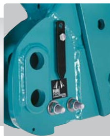
Strzałka ustawienia w poziomie i pod kątem dla rozsiewu późnego
