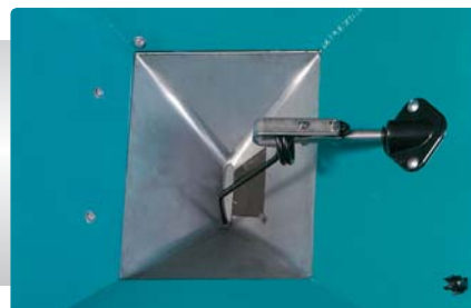
Denko zsykowe ze stali nierdzewnej i sprężyste mieszadło
