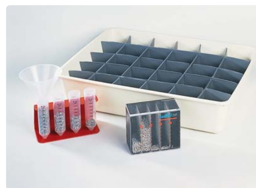
Zestaw kontrolny do sprawdzenia szerokości pracy (opcja)
