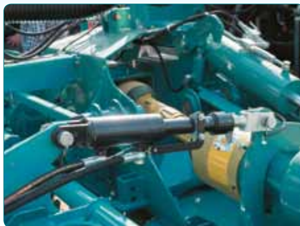
Wydźwig hydrauliczny dla belki z sekcjami wysiewającymi dwutalerzowymi TWINDISC.
