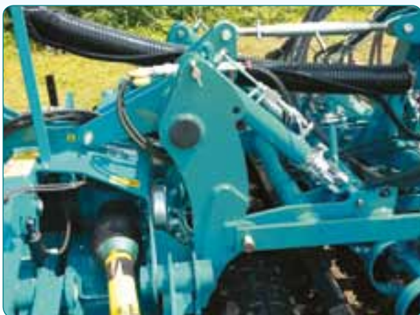
Wydźwig hydrauliczny dla talerzowych sekcji wysiewających CULTIDISC i w przypadku współpracy z siewnikiem punktowym. Udźwig maksymalny: 3,5 tony.
