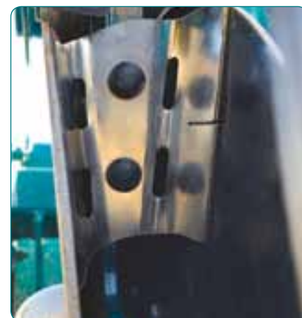
Skrobak talerza hartowany na redlicy dwutalerzowej TWINDISC, stosowany w intensywnych warunkach pracy lub podczas siewu na glebach o właściwościach ściernych.
