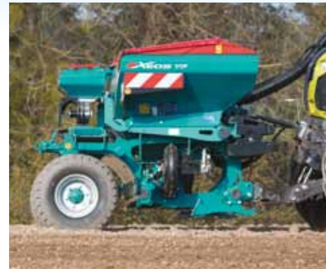
Zbiornik czołowy poj. 1800 l + DUO 70 l Wał z kołami ogumionymi i obciążniki tylne
