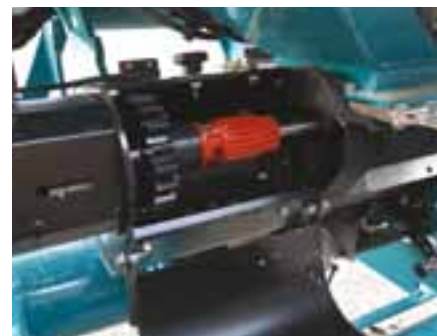
Uniwersalny dozownik: zmiana ustawienia z drobnych ziaren na grube ziarna odbywa się poprzez przestawienie.
