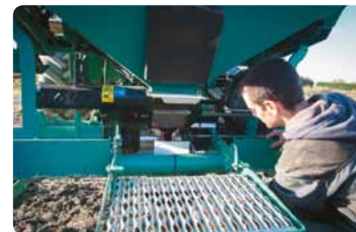
Napęd elektroniczny dozownika w wyposażeniu seryjnym: łatwy i ergonomiczny dostęp do bezpiecznej regulacji. Łatwiejsze opróżnianie zbiornika.
