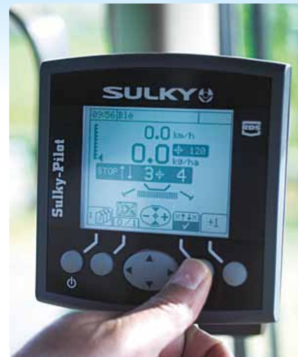
Konsola elektroniczna PILOT z dużym, podświetlanym wyświetlaczem
