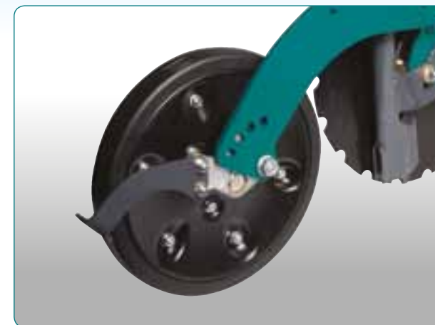
Koło dociskowe z metalowym kółpakiem w wyposażeniu sekcji talerzowej CULTIDISC. Koło dociskowe jest zalecane w przypadku współpracy z agregatem talerzowym Cultiline XR lub gdy gleba jest zakamieniona.
