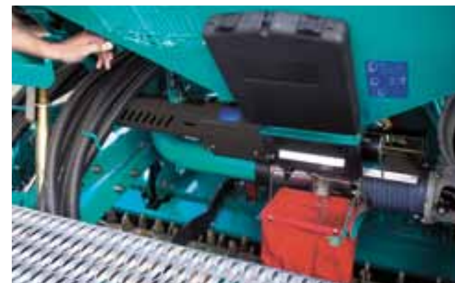
Dozownik SULKY zapewnia wysoką wydajność podczas pracy w polu i w czasie przeprowadzania ustawień. Do próby kręconej niczego nie trzeba demontować, wszystkie ustawienia znajdują się w pobliżu dozownika.
