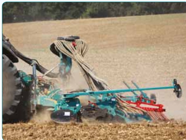
Znaczniki przejazdowe na bronie wirnikowej HRW Składanie do poziomu i wymiary gabarytowe maszyny ułatwiają pracę na końcu pola. Podwójne zabezpieczenie aktywne i bierne chroni maszynę, dzięki temu jest trwalsza.
