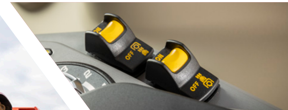
Elektrohydrauliczny wybór prędkości wałka WOM
