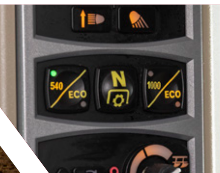
Elektrohydrauliczny wybór prędkości wałka WOM
