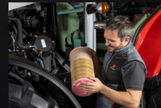
Filtr powietrza silnikowego jest łatwo dostępny oraz wygodny w czyszczeniu.
