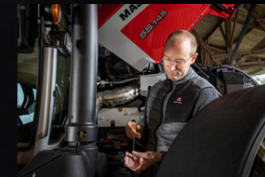
Konstrukcja przedniej osi oraz smukła i wąska maska ułatwiają dostęp do bagnetu poziomu oleju i filtra.
